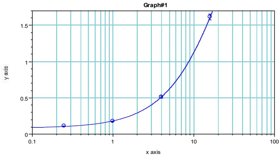
4-P Fit:  $y = (A - D) / (1 + (x/C)^B) + D$ :      A      B      C      D      R<sup>2</sup>
